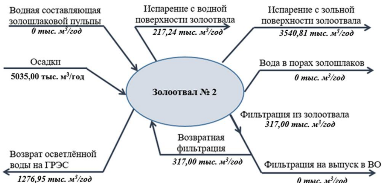
Рисунок 2.4. Водный баланс золоотвала № 2 в средний по водности год на конец рекультивации
