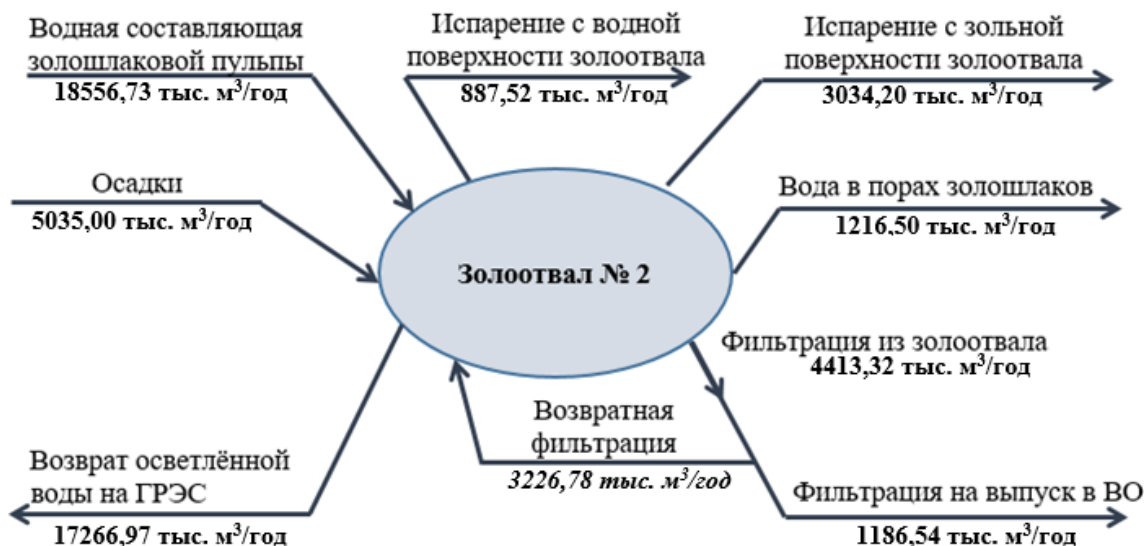
Рисунок 2.3. Водный баланс золоотвала № 2 в средний по водности год на начало рекультивации
