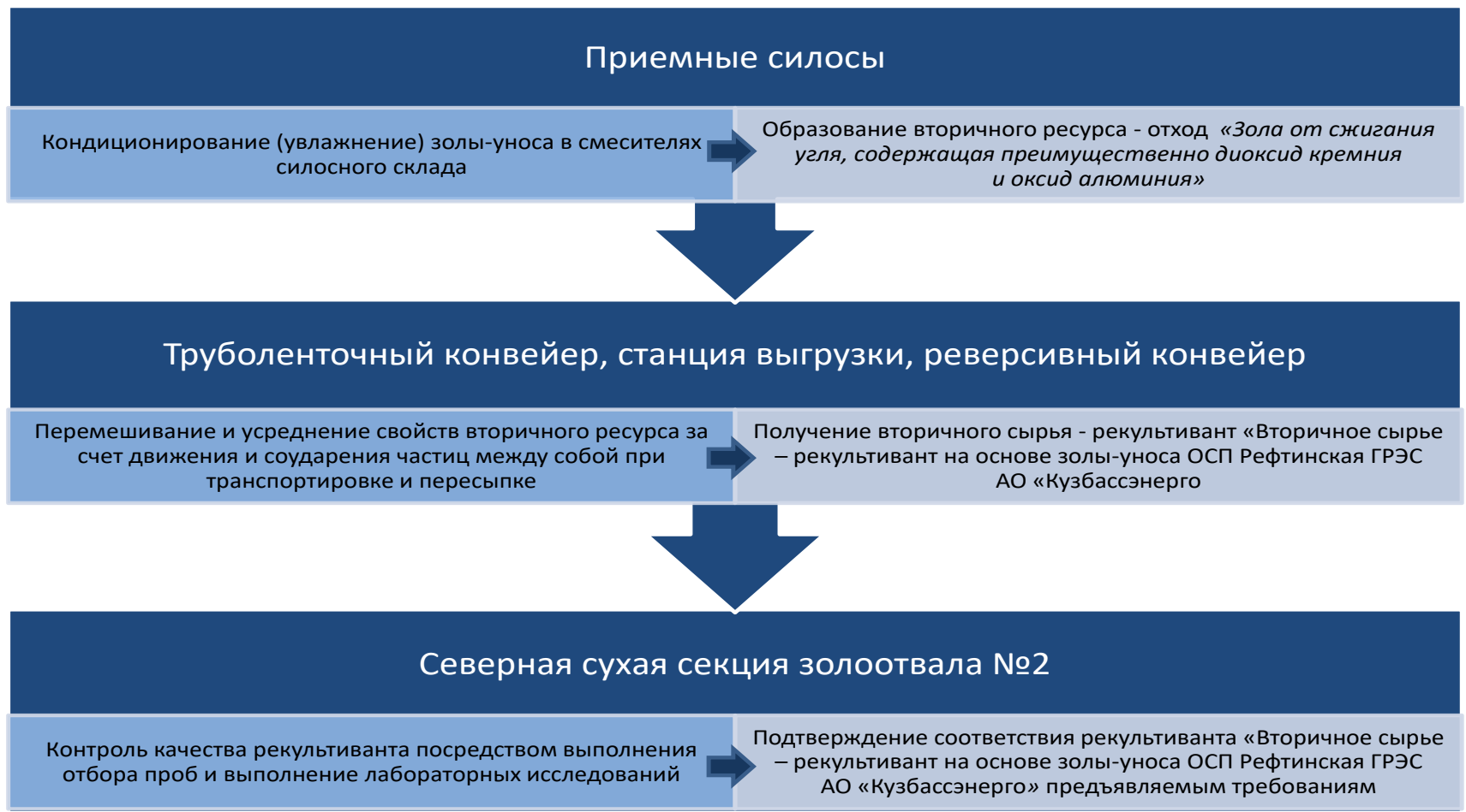
Рисунок 2 – Схема производства рекультиванта «Вторичное сырье – рекультивант на основе золы-уноса ОСП Рефтинская ГРЭС АО «Кузбассэнерго»
