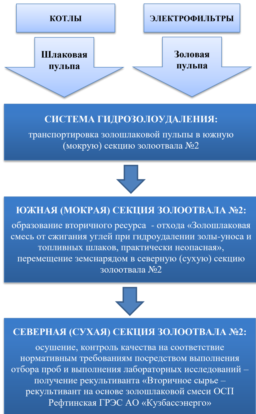
Рис. 2 – Схема производства рекультиванта «Вторичное сырье – рекультивант на основе золошлаковой смеси ОСП Рефтинская ГРЭС АО «Кузбассэнерго»
